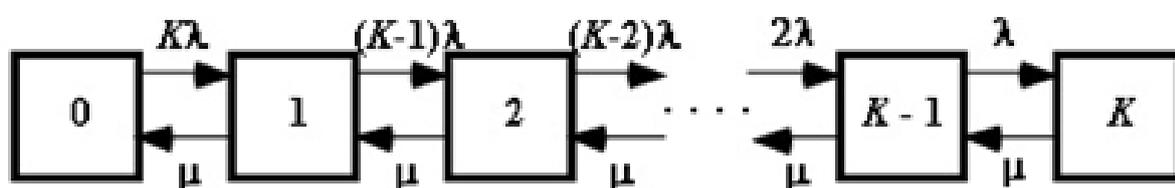
FIGURE 2.7 – Evaluation de l'état dans la file d'attente  $M/M/1/K$
