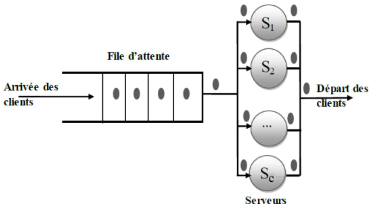
FIGURE 2.3 – Système de file d’attente à  $C$  serveurs parallèles.
