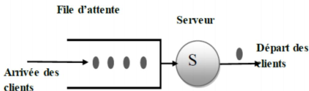
FIGURE 2.2 – Système de file d'attente avec un serveur unique.
