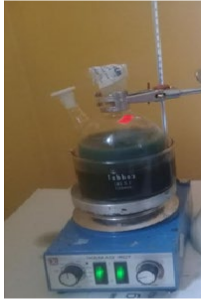
Fig. IV.2. Synthèse des Fe-HDLs par la méthode de co-précipitation.
