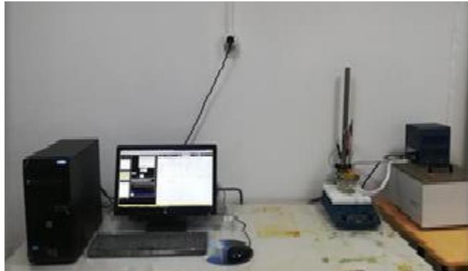
Figure III-5. Dispositif potentiostat de type SP-150
