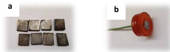
**Figure III-3.** Echantillons d'acier doux découpé (a) Électrode de travail enrobé par la résine (b)
