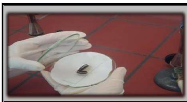
Photo II-II-2. Technique de Microculture pour l'identification microscopique des moisissures.
