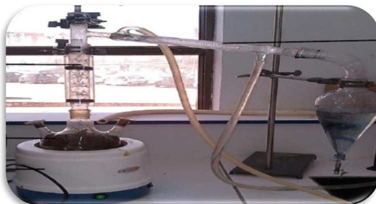
Figure II.10 : Dispositif d'extraction des huiles essentielles par hydro-distillation
