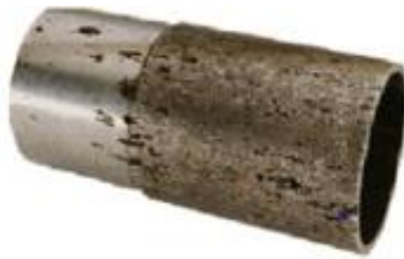
Figure I.5 : Corrosion par piqûres d'un acier inoxydable [19].
