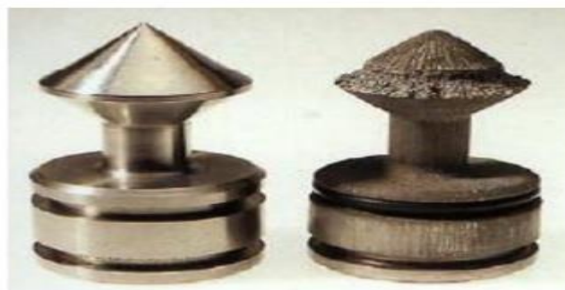
Figure I.9 : Corrosion-érosion due à de fortes vitesses de circulation du fluide corrosif (pointeau de vanne en alliage nickel-cuivre) [14].
