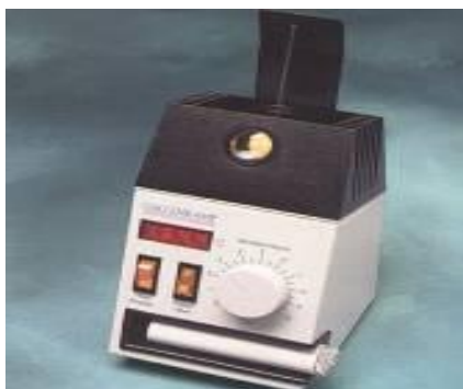
Figure B-1-3- appareil Électrothermique de type Gallenkamp.
