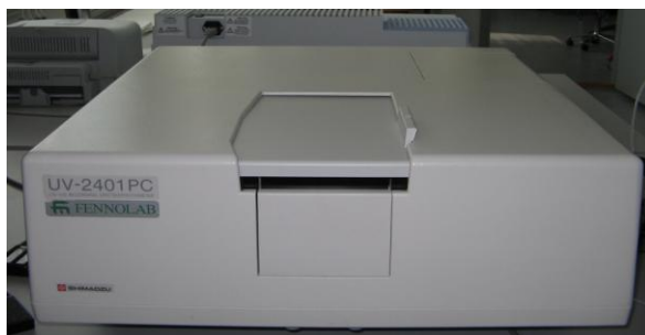
Figure B-1-5- Spectromètre UV-Visble de type shimadzu UV-2401PC.
