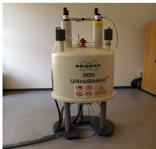
Figure B-1-7- appareil RMN de type BRUCKER AM (300MHz)
