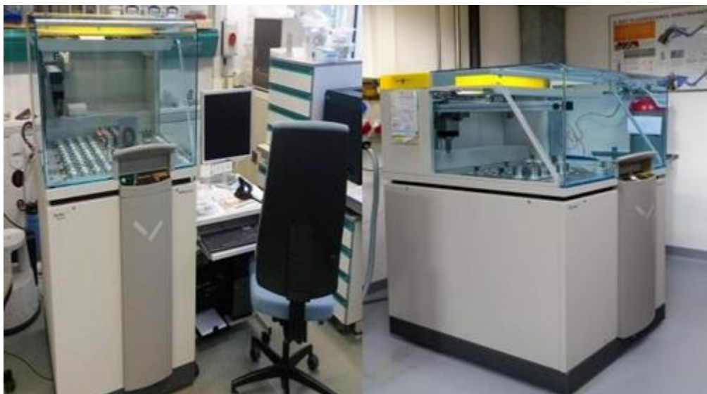
Figure. IV.4: Appareil d'analyse de DRX et fluorescence (XRF)
