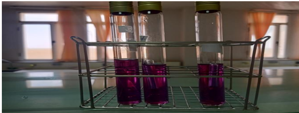
Figure V.26:Test présomptif de dénombrement des CT dans un liquide.
