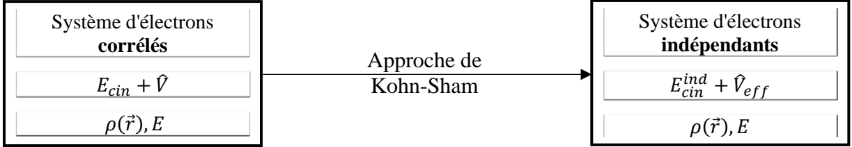
Figure II.1. Modélisation d'un système d'électrons corrélés par un système d'électrons indépendants (Approche de KS).
