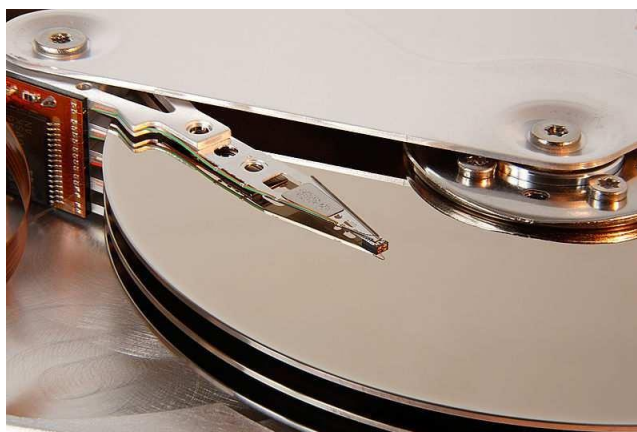
Fig.II.2 : Détail d'un bras avec sa tête reposant sur un plateau de disque dur
