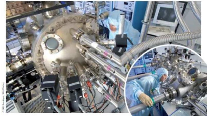
**FigII.4** : dispositif pour la fabrication des couches minces.
