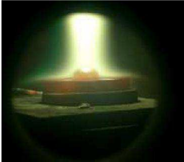
Figure 3: Echantillon de silicium fondu sous plasma sur substrat de graphite
