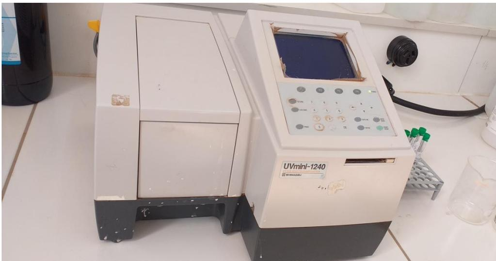
**Figure IV.3:** Appareil de spectrophotomètre UV-Visible
