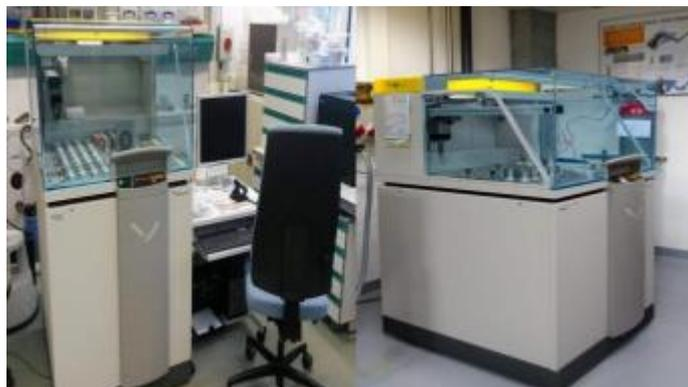
**Figure IV.1** : Appareil d'analyse fluorescence X (XRF)
