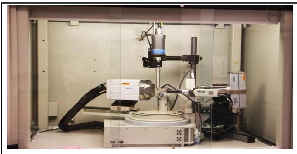
**Figure II.13 :** Diffractomètre de rayons X Bruker Apex CCD.
