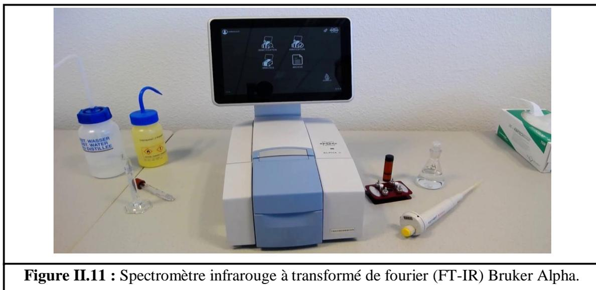
**Figure II.11** : Spectromètre infrarouge à transformé de fourier (FT-IR) Bruker Alpha.
