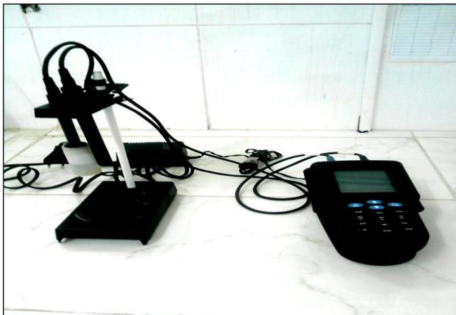
**Figure N°17** : Multi paramètre (température, PH, conductivité, salinité, taux des substances dessous, oxygène dissous, potentiel redox, Saturation en Oxygène).
