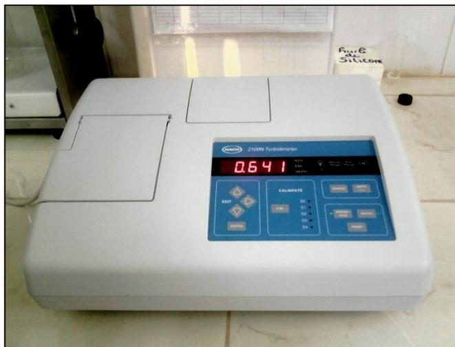
**Figure N°26 :** Le turbidimètre HACH 2100 N.
