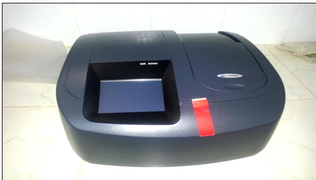
**Figure N°35:** spectrophotomètre UV visible DR5000
