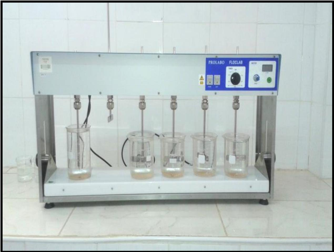
Figure N° 16:Appareil jar test
