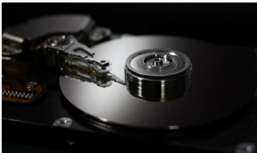
Figure I-10 Détail d'un bras avec sa tête reposant sur un plateau de disque dur.
