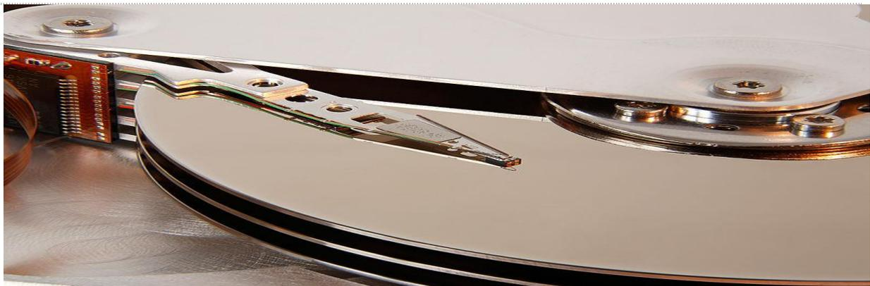
**FigII.3** : Détail d'un bras avec sa tête reposant sur un plateau de disque dur
