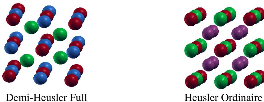
**Figure II.3** : Structure Cristalline de demi-Heusler et Full Heusler Ordinaire.
