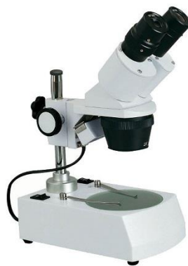
Figure. I.3. Microscope optique binoculaire pour le choix du monocristal
