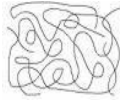
Figure II.5: Schéma de la structure d'un polymère amorphe.
