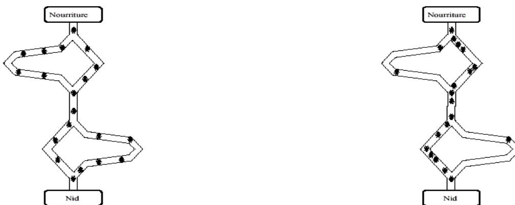
Figure.III.2 : Expérience de sélection des branches les plus courtes par une colonie de fourmis : (a) au début de l'expérience, (b) à la fin de l'expérience. [6]
