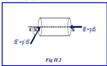
Par conséquent, la pression hydrostatique en un point donné d'un fluide au repos est la même dans toutes les directions.
