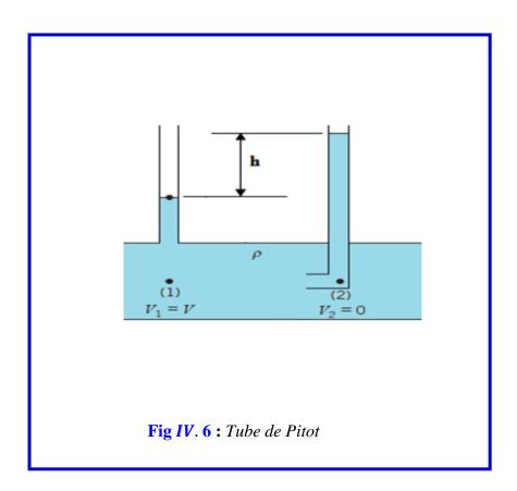
Le principe est base sur la mesure de la pression statique et de la pression dynamique en un point d'un écoulement.
