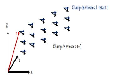
En mécanique des fluides, on ne s'intéresse généralement pas à la trajectoire individuelle des particules. Ce qui intéresse, c'est de savoir comment varie la vitesse en tout point de l'écoulement à tout instant, c'est pour cette raison que la description eulérienne est la plus utilisée.
