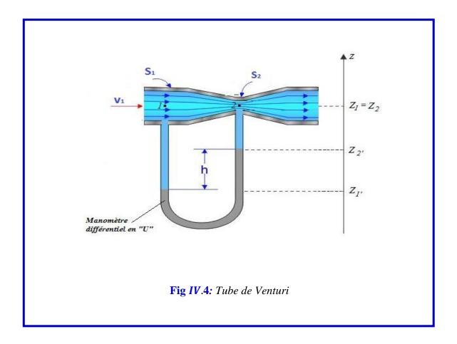
On appliquant le théorème de Bernoulli sur une ligne de courant entre les deux points (1) et (2), on obtient :
