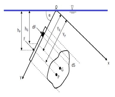
Fig II.6: Force exercée par un fluide au repos sur une paroi solide fixe
