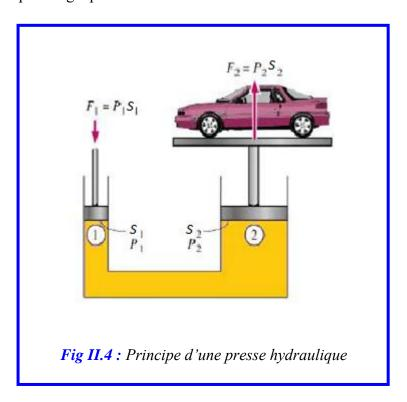
Lorsque les deux pistons 1 et 2 sont sur le même niveau ( $Fig.\ II.4$ ), on a :  $p_1 = p_2$
