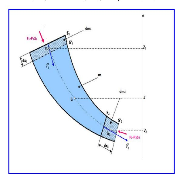
On applique le théorème de l'énergie cinétique entre les instants t et t+dt. La variation de l'énergie cinétique  $\Delta E_c$  est égale à la somme des travaux des forces extérieures (poids de l'élément fluide, forces de pression).
