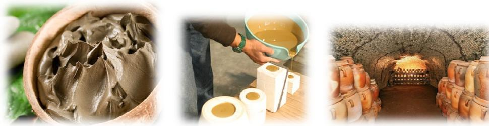
**Figure N°5: Etapes de la fabrication des ceramiques traditionnelles[4].**
