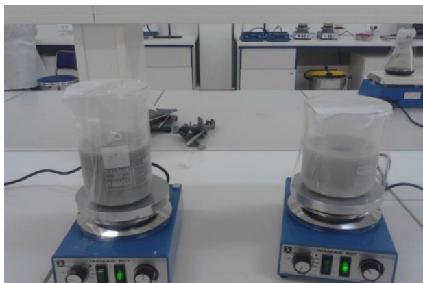
Fig. III. 3. Agitation du verre obtenu à partir de la fusion alcaline
