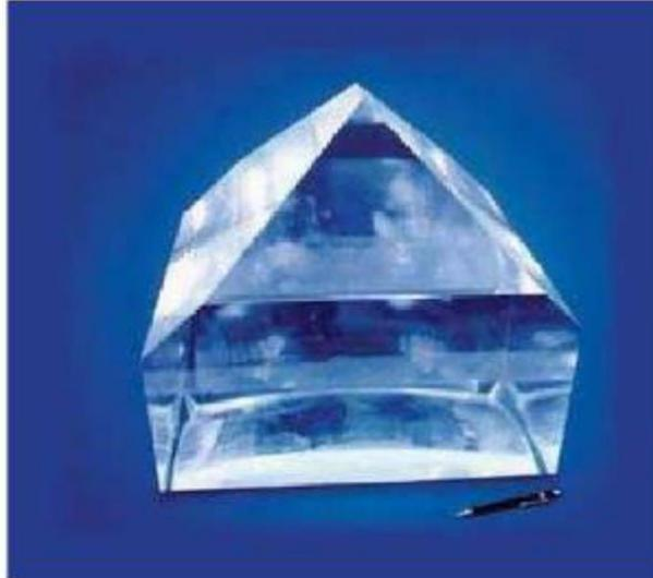
Figure. II.1. Monocristal de KDP ( $\text{KH}_2\text{PO}_4$ ).
