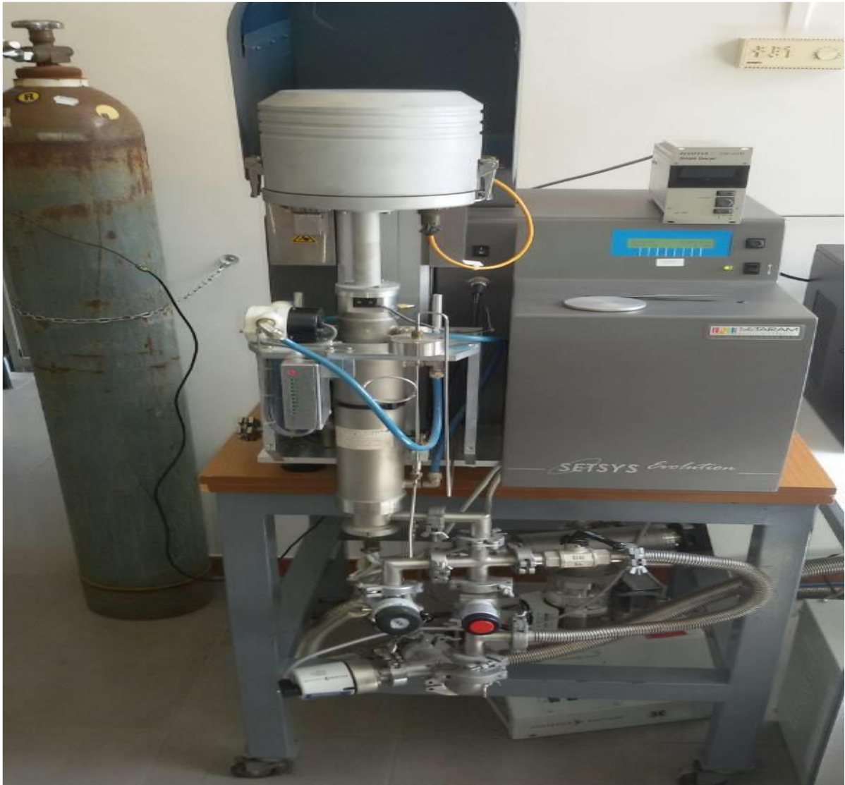
Figure (III .3) : Montage des mesures thermique (ATG-DTG) par Setaram Setsys 1200 TG.
