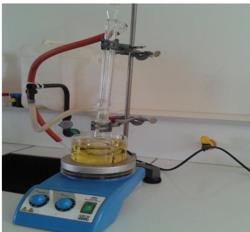
Figure(III.2) : Le montage à reflux pour la synthèse des liquides ioniques.
