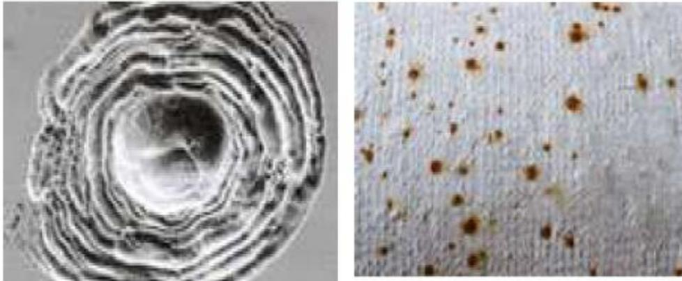
*Fig. I. 2 Corrosion par piqure*
