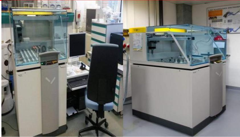
**Figure IV.10** : Appareil d'analyse fluorescence X (XRF)
