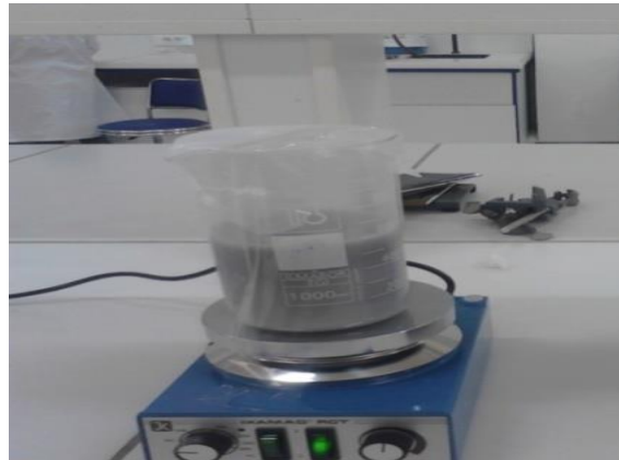
Fig.III.2. synthèse des nanocomposites \text{Fe}_3\text{O}_4 -HDL
