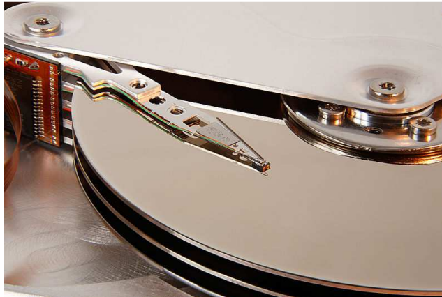
FigII.3 : Détail d'un bras avec sa tête reposant sur un plateau de disque dur
