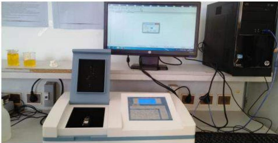
**Figure IV.1:** spectrophotomètre UV-Visible UV mini-1240 SHIMADZU.
