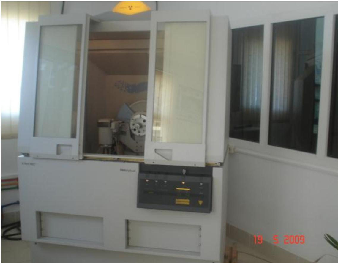
**Figure IV.20:** Appareil de Diffraction des Rayons X. modèle X'PERT Pro Philips Analytical
