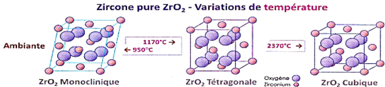
Figure III.2 : Structures cristallographiques en fonction de la température pour la zircone pure ( ZrO_2 ).
