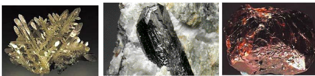
Figure III.1 : Cristaux de baddeleyite (à gauche), fragment de baddeleyite (au milieu) et de zircon (à droite).
