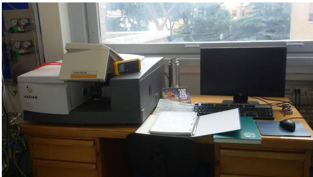
Figure III.7 : Spectromètre IR Agilent Cary 660.
