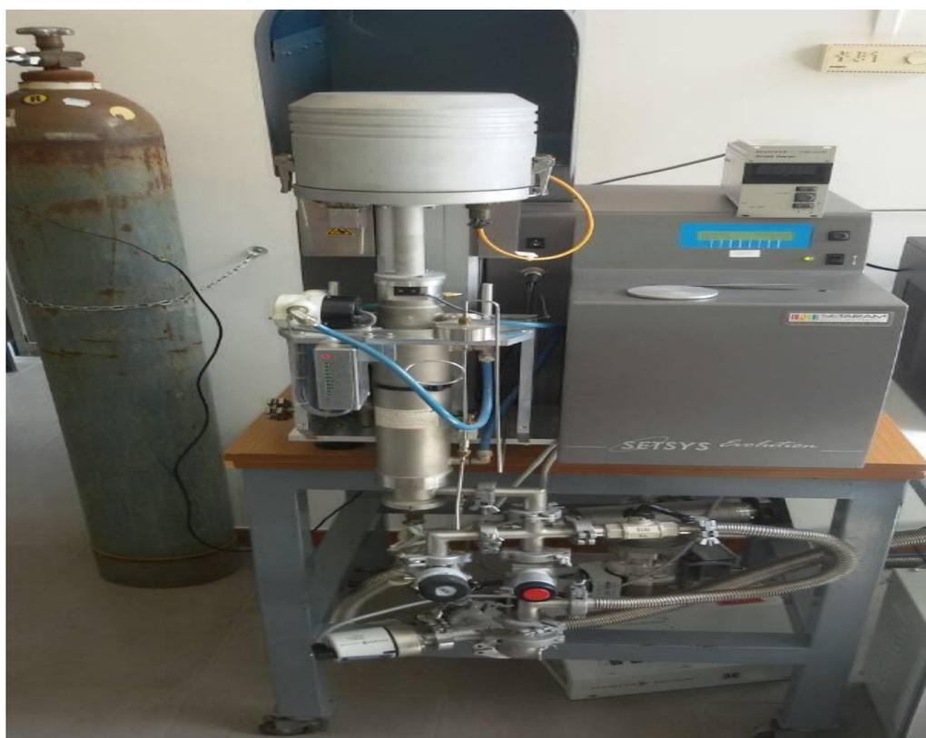
**Figure III.8 :** Montage des mesures thermique (ATG-DTG) par Setaram Setsys 1200 TG.
