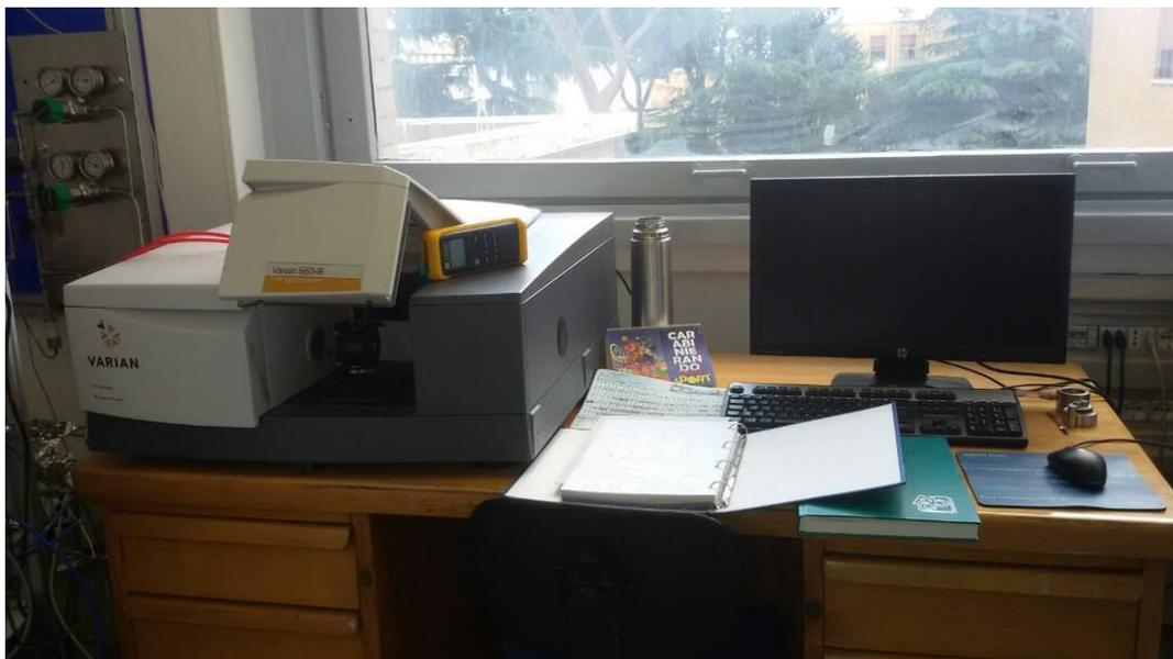
**Figure III.9 :** Spectromètre IR Agilent Cary 660
