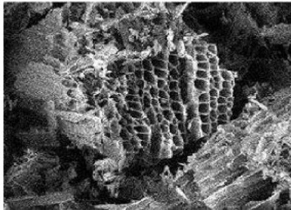
**Figure I.1:** Structure du charbon actif vu sous un microscope électronique<sup>3</sup>
