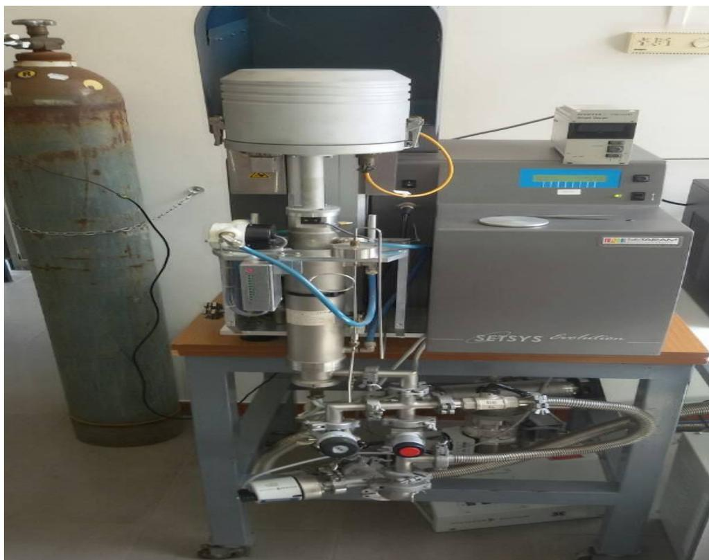
**Figure III.10 :** Montage des mesures thermique (ATG-DTG) par Setaram Setsys 1200 TG
