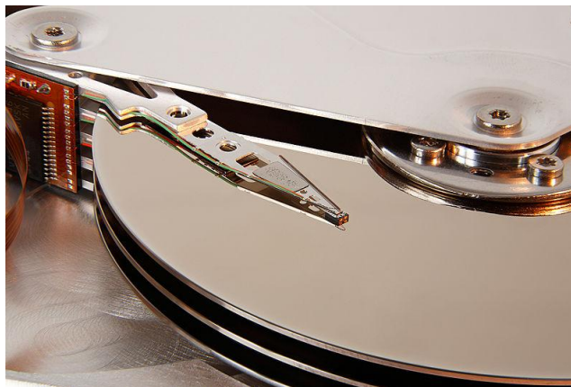
Fig.2 : Détail d'un bras avec sa tête reposant sur un plateau de disque dur
