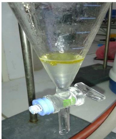
Figure III.3 : Ampoule à décanter contient le produit récupéré
