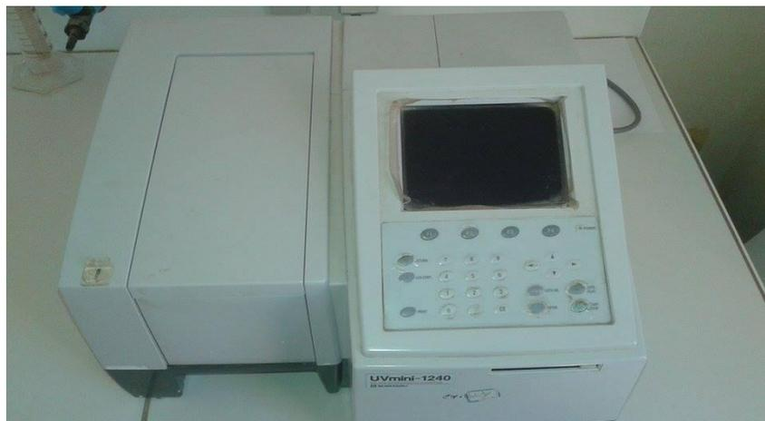
Figure (III.6) : spectrophotomètre UV-Visible.
