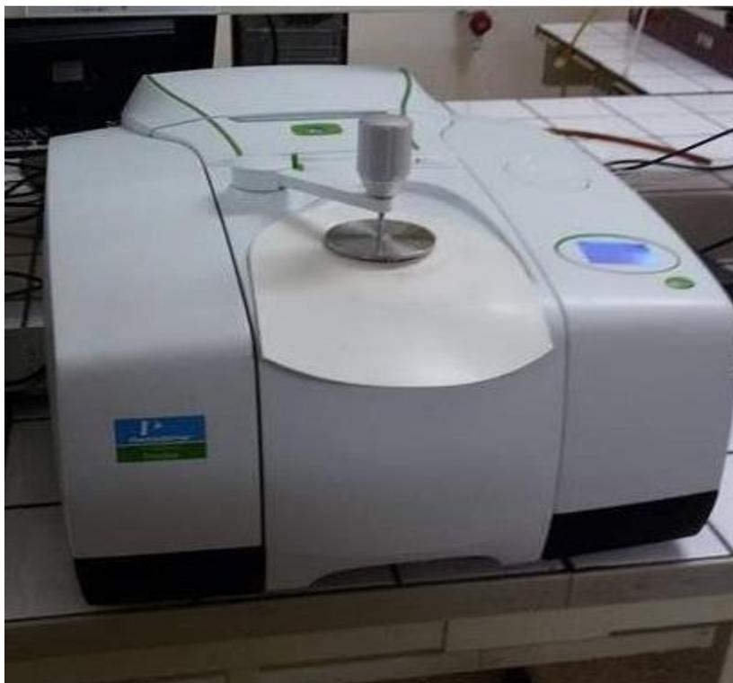
**Figure (III.8) :** Spectrophotomètre IRTF.
