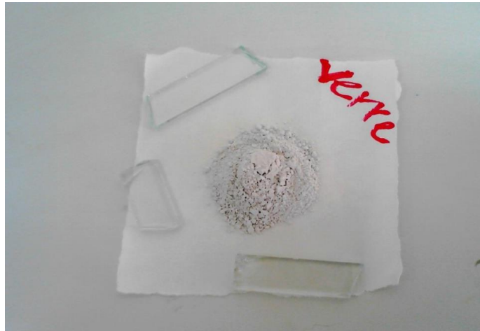
Fig III-1 Le verre usé utilisé dans la synthèse du MCM-41
