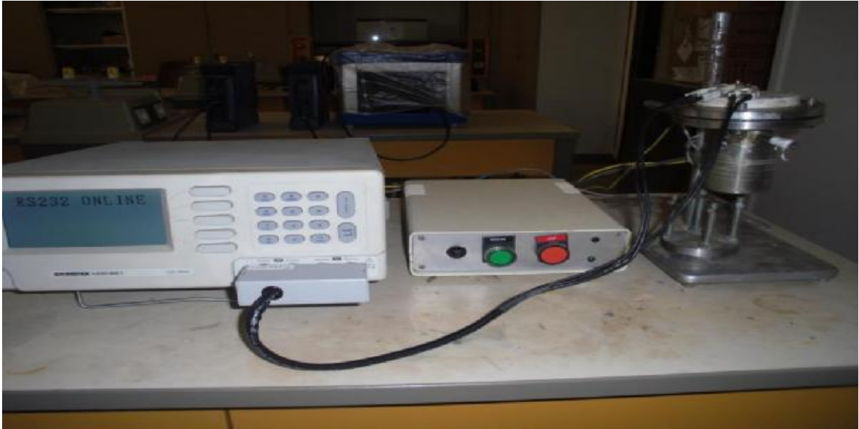
Figure(III.4) : régulateur thermique relié avec impédance mètre GWINSTEK, LCR-821 (LSCT)
