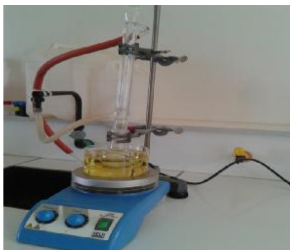
Figure(III.1) : Le montage à reflux pour la synthèse des liquides ioniques.
