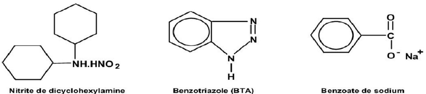
Figure 11 Quelques inhibiteurs organiques de corrosion
