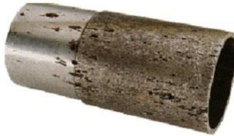
**Figure 5 :Corrosion par piquures d'un acier inoxydable [11]**
