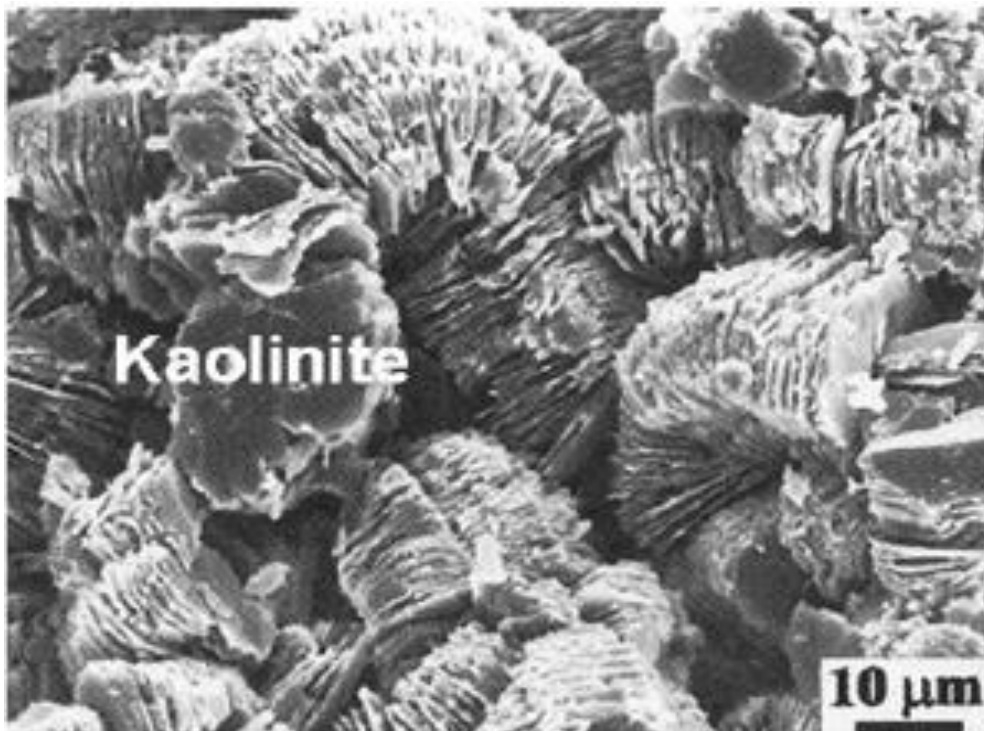
Figure (I.8) : Schéma représentative des cristaux de kaolinite vus au microscope électronique à balayage [8].
