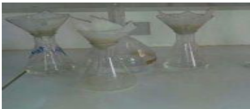
Figure (III.5) : Mode de filtration des mélanges (bentonite +ILs).
