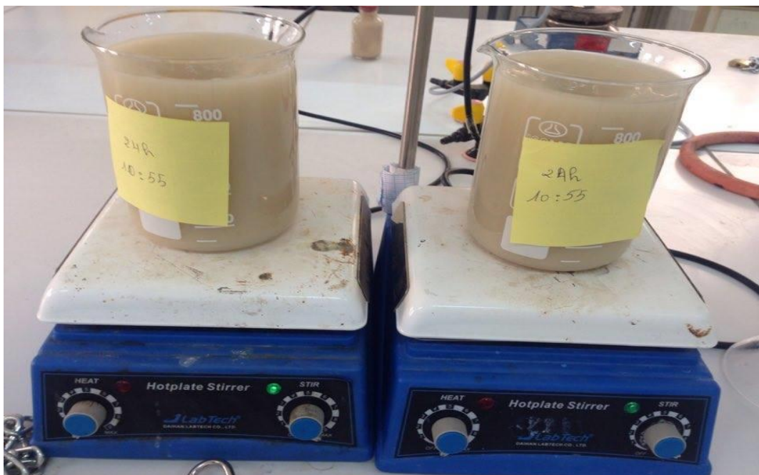
Figure (III.1) : la mode de purification de la bentonite naturelle.
