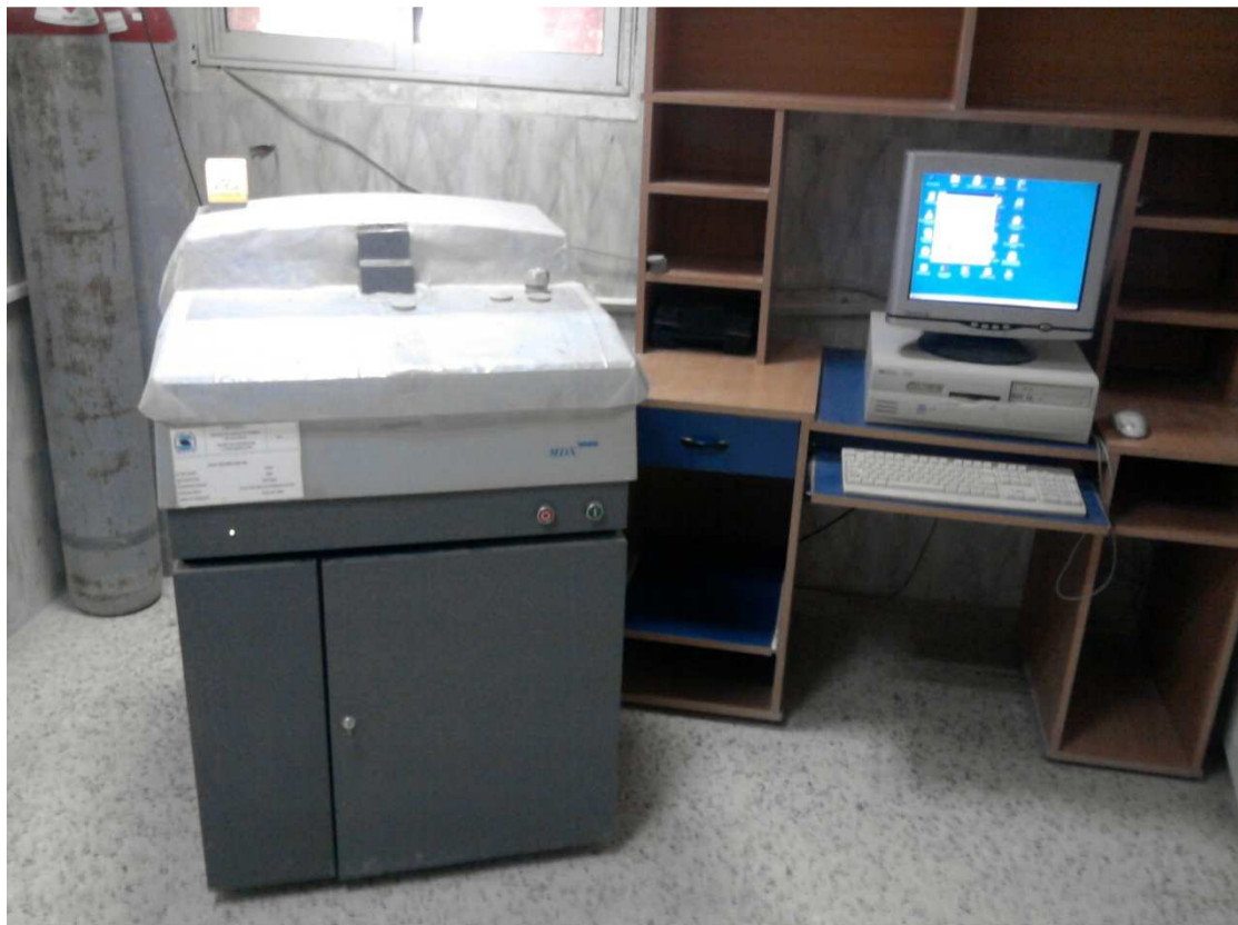
Figure 13 : spectromètre de fluorescence X (cimenterie de Saida).
