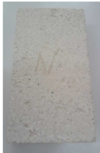
Figure 25 : brique refractaire après cuisson
