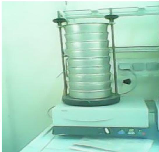
Figure 15 Photo du Tamis mécanique modale RETSCH AS 200 digital
