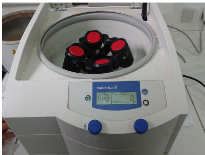
**Fig III-8 photo de la centrifugeuse utilisée pour la séparation**
