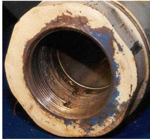
*Fig. I. 3 Corrosion Galvanisée*
