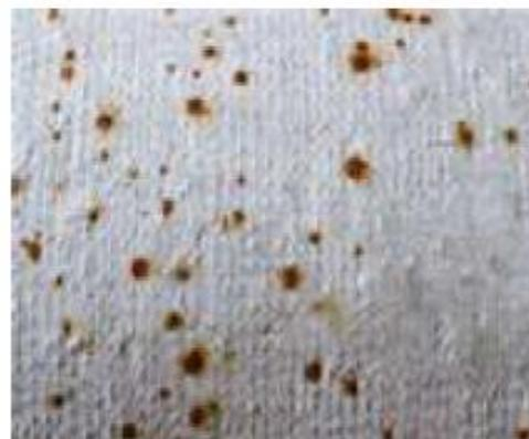
*Fig. I. 2 Corrosion par piqure*
