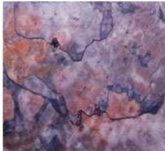
*Fig. I. 4 Corrosion sous contrainte*
