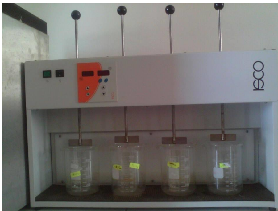
Figure-6 Jar-test de type ISCO
