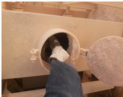
Figure-3 point de prélèvement au niveau du filtre à manche .
