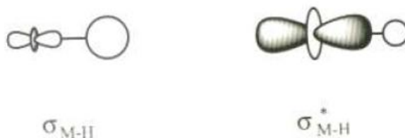
Figure 1.19: Les OM des liaisons \sigma_{M-lig} liantes développées sur les orbitales des ligands et antiliantes développées sur les orbitales du métal
