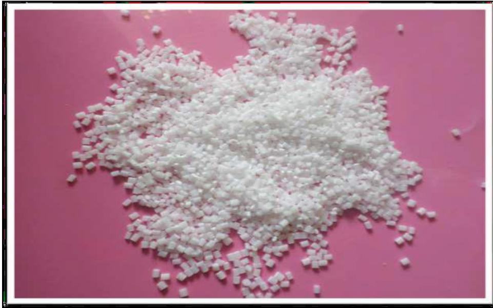
**Figure.12.** photo des cristaux de Polystyrène choc.
