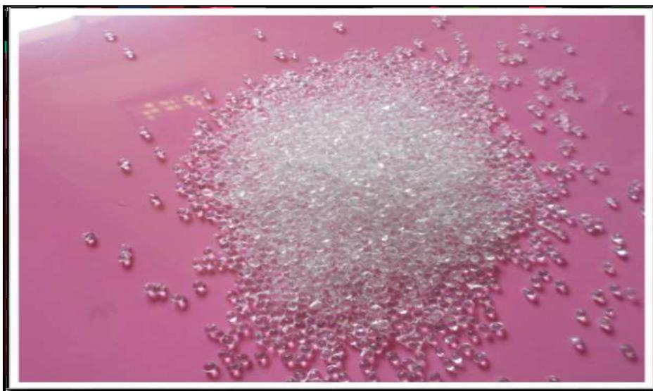
**Figure.11.** photo des cristaux de Polystyrène cristal.
