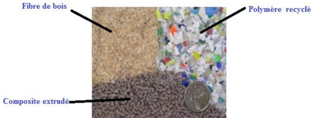
**Figure.16.** fibres de bois, polymère recycle et composite extrudé.
