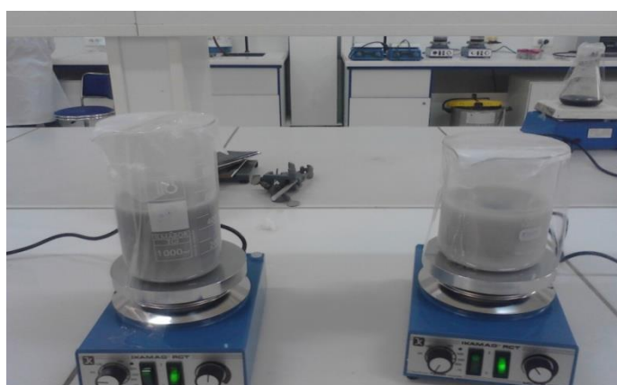
Fig. III. 2. Photo d'agitation du verre obtenu à partir de la fusion alcaline
