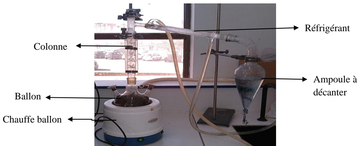
Figure III.1 : Montage utilisé pour l'extraction des huiles essentielles de l'absinthe par la méthode d'hydro-distillation.
