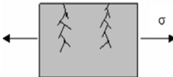
Figure I.4 : Corrosion sous contrainte.
